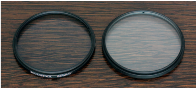
Links ein Rodenstock-Filter HR Digital UV mit hocheffektiver Super-MC-Vergütung, rechts ein unvergütetes UV-Sperrfilter. Das linke Filter mit nur 0,2% Reflexion zeigt so gut wie keine Spiegelung mehr.
